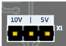
Fig. 7. Puente de 10V | 5V
